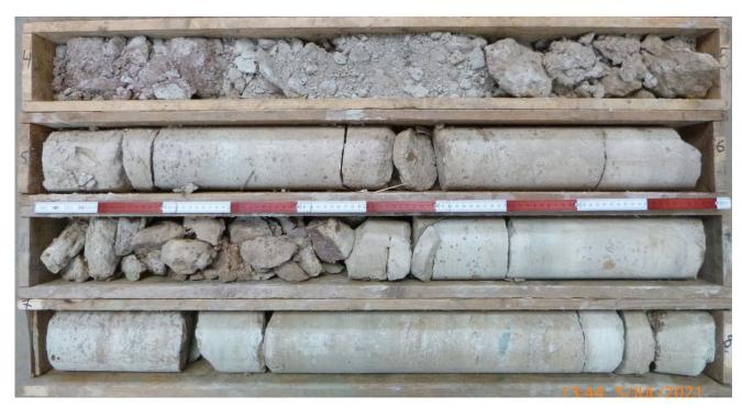
**Abbildung 5.2:** Bohrkern der Bohrung KB 2 vom Tiefenbereich 4,00 m bis 8,00 m u.GOK. <u>Beachte:</u> die angetroffenen Verwitterungsstufen des Tigerstandsteins (a) w 4 – w 5 (Schicht 4a, Tiefenbereich 4,00 m bis 5,00 m u.GOK), (b) w 3 (Schicht 4a, Tiefenbereich 6,00 m bis 6,60 m u.GOK und 6,60 m bis 8,00 m u.GOK.
