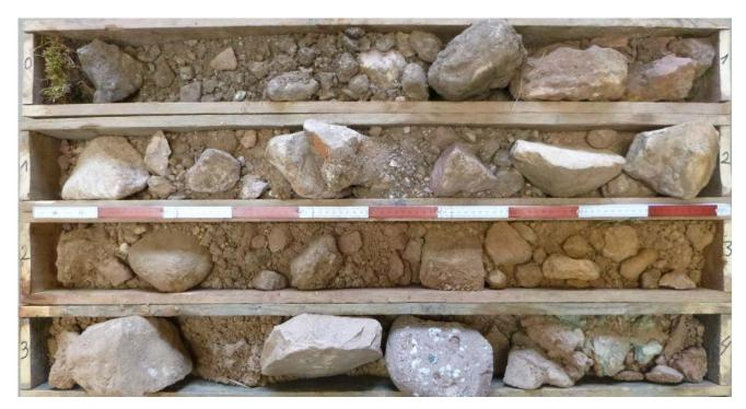
**Abbildung 5.1:** Bohrkern der Bohrung KB 1 vom Tiefenbereich 1,00 m bis 4,00 m u.GOK. <u>Beachte:</u> den Übergang von kantigen Gesteinsbruchstücken in der grauen Auffüllung (Schicht 2, Tiefenbereich 0,10 m – 1,80 m u.GOK) zu kantengerundeten Bruchstücken in den rötlich bis ocker farbenen Verschwemmungssedimenten (Schicht 3, Tiefenbereich 1,80 m bis 3,80 m u.GOK).
