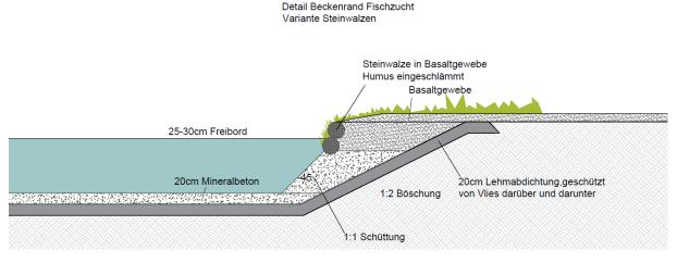
Abbildung 8: Schnitt Uferbefestigung
