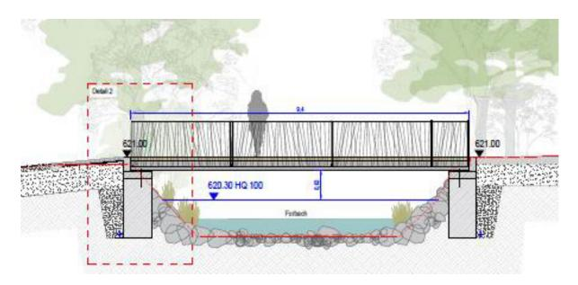
Abbildung 15: Schnitt Steg über den Forbach bei der Grube Dorothea (siehe Plan FIII 8.04 Übersichtsplan + Steg und Brücken, mit Schnitten und Details)
