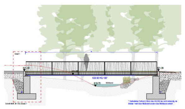
Abbildung 16: Schnitt Steg über den Mühlkanal (siehe Plan FIII 8.04 Übersichtsplan + Steg und Brücken, mit Schnitten und Details)
