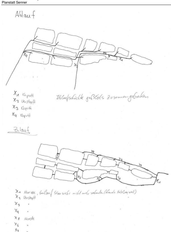
Abbildung 6: Zu- und Abläufe der Fischbecken, Handskizze, Q. Herr Schindler
