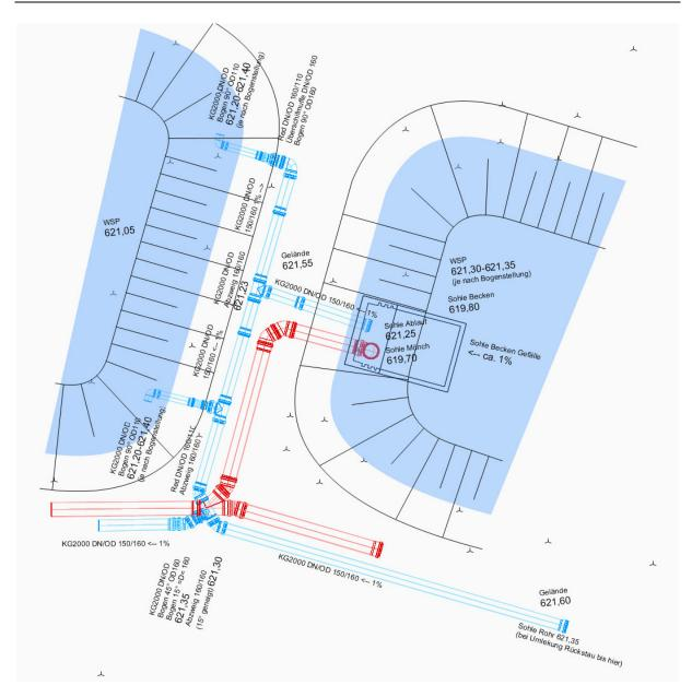
Abbildung 10: Detail Zuleitungssystem
