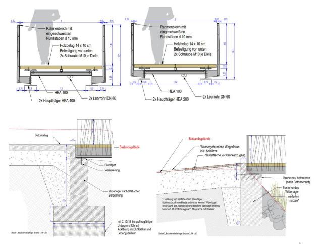
Abbildung 17: Regelquerschnitt Brücke und Brückenwiederlager (siehe Plan FIII 8.04 Übersichtsplan + Steg und Brücken, mit Schnitten und Details)
